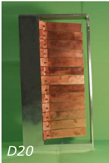
Monochromator Cu(200) Focalisation Verticale
