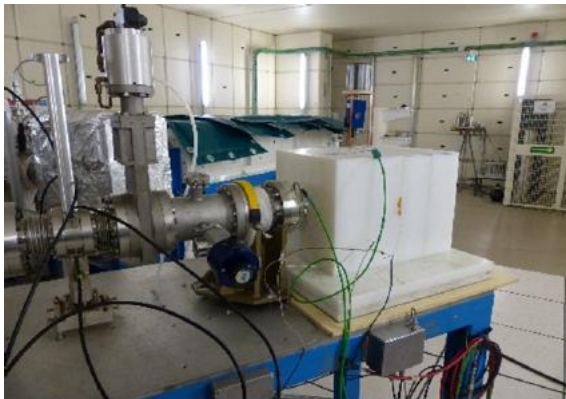
Le dispositif de production et de modulation des neutrons ainsi que (au fond de la casemate) le détecteur Hélium
