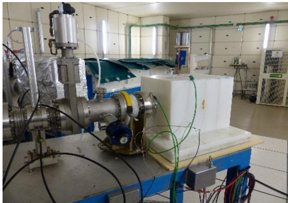
Le dispositif de production et de modération des neutrons ainsi que (au fond de la casemate) le détecteur Hélium
