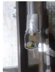
Monocristal de PbTe monté sur la canne
